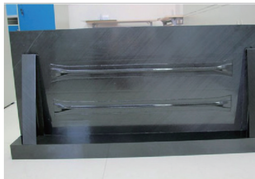
图4 采用HFVI技术研制的民机襟翼典型结构件
